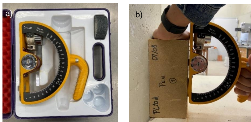
Figura 24 – Ensaio com o esclerômetro pendular: a) Equipamento; b) Medição
