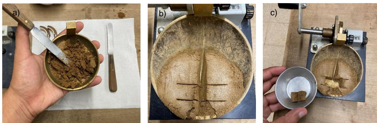
Figura 9 – Determinação do limite de liquidez: a) mistura da terra com água; b) colocação da terra na concha de Casagrande; c) recolha da amostra para levar à estufa.
