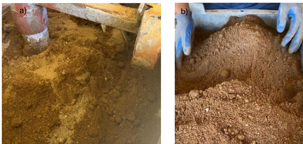
Figura 17 - Mistura: a) Produção da mistura na betoneira; b) Produção manual.
